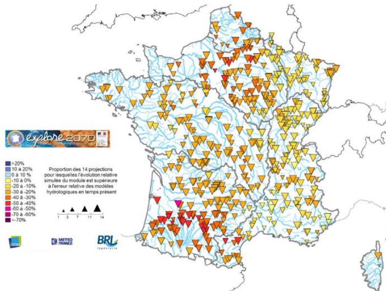
Figure 21 : Evolutions relatives possibles (en %) du QMNA 52 entre 1961-90 et 2046-65. Résultats moyens établis sur 14 simulations (Chazot et al., 2012)
