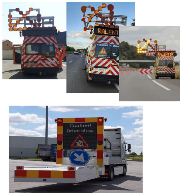
Figure 34 - Exemples de signalisation davantage fusible (source : DMR)
