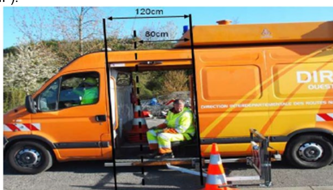
Figure 31 - Illustration d'un dispositif d'aide à la pose et de dépose de cônes de balisage
