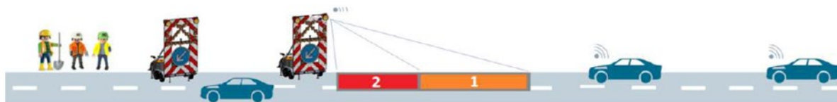
Figure 8 - Principe du système d'alerte en cas d'intrusion dans la zone d'intervention (source : DMR)
