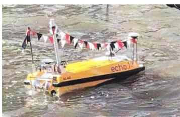
**Figure 7: Surveillance bathymétrique port de Hambourg**
