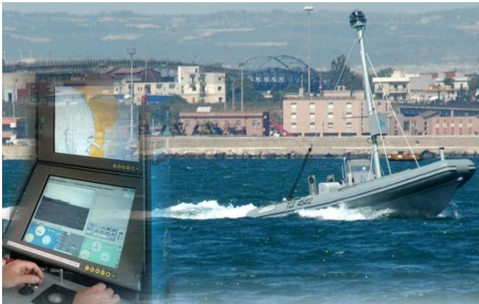
**Figure 5 : Transformation en drone par ECA GROUP et supervision (source ECA Group)**
