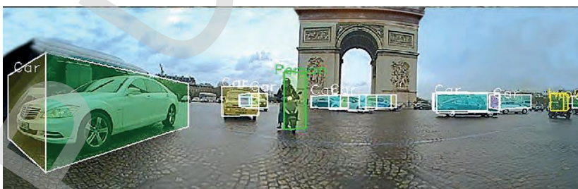
Figure 1 : Expérimentation Place de l'Étoile à Paris, dans le cadre du projet Deep Perception (CEA/ Valéo) du logiciel Deep Manta du CEA-List qui permet de détecter en 2D et en 3D les objets d'intérêts sur la route. Source : Les défis du CEA n°230, septembre 2018
