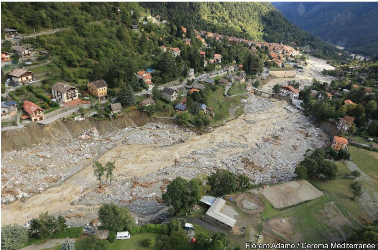
**Figure 2 - Engravement, divagations amont et importantes érosions latérales, notamment accentués par la contraction du lit du Boréon à Saint-Martin-Vésubie (réduction de la vitesse d'écoulement en crue et de la capacité de transport solide).**
