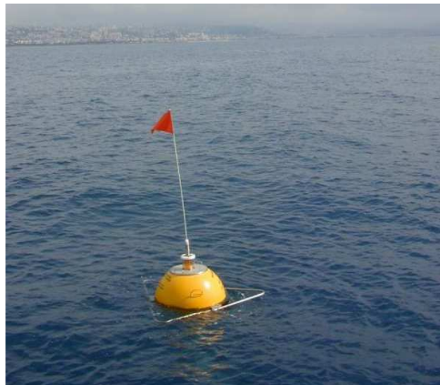
Figure 26 : Bouée houlographique du réseau CANDHIS
