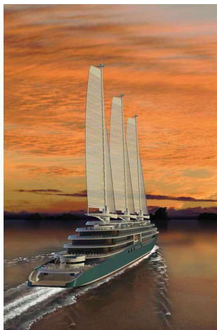
photo 9: Paquebot à voiles de 190 m de long, 23 000 t. (Crédit : Chantiers de l'Atlantique)
