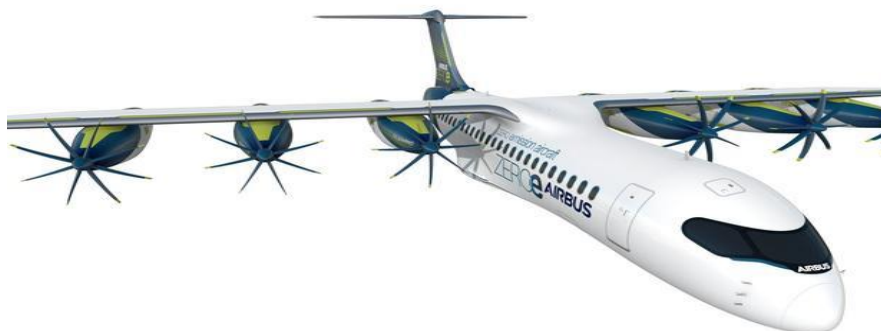
Figure 7 : Concepts d'avion hydrogène imaginé par Airbus équipé de 6 pods rechargeables placés sous les ailes 31 .
