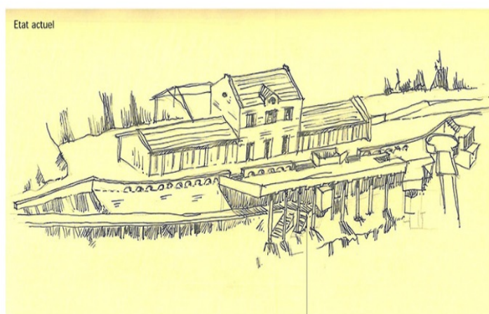
Terrasse actuelle : dalle béton sur pilotis couvrant un passage piéton permettant d'accéder au départ de la télécabine. L'accès se fait en empruntant un emmarchement depuis le niveau de la gare. Le raccordement de la terrasse masque largement la présence du mur de soutènement en maçonnerie.
