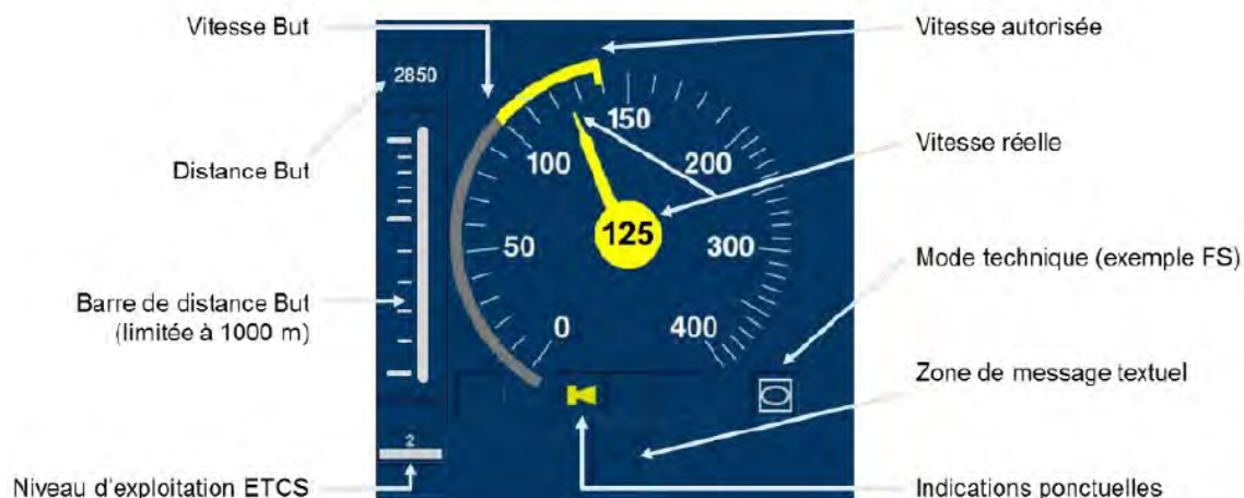
Illustration 15: affichage en cabine de conduite d'ETCS (source : EPSF)
