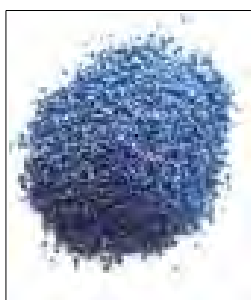
Produit en matière TLC : nouvelle matière première pour le secteur de la plasturgie (Cf. Photo extraite du rapport d'activité sur le bilan à mi-parcours de l'agrément 2014-2019, Eco-TLC).
