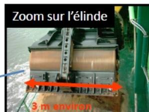
Un tuyau articulé et relié au navire (élinde) traîne sur le fond un bec d'élinde qui aspire au moyen d'une pompe un mélange "eau-granulats" déversé ensuite dans la ou les cales du navire ; le surplus d'eau généré par le pompage est restitué à la mer
