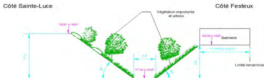
Schéma type du cavalier minier en contrebas de la rue des Festeux
