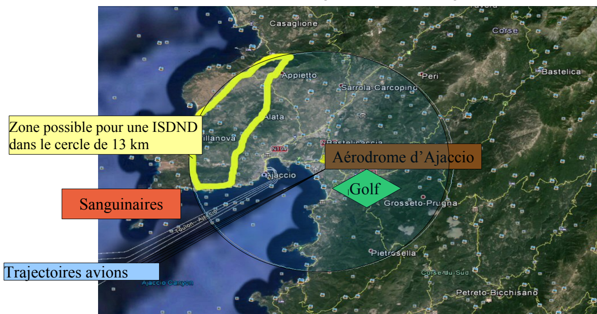
Illustration 2 : Au sein du périmètre de vigilance représenté par un cercle de 13 km de diamètre centré sur l'aéroport d' Ajaccio, les échanges entre la mission et la DGAC ont permis d'identifier une zone approximative représentée en jaune permettant le cas échéant l'implantation d'une ISDND (source mission).
