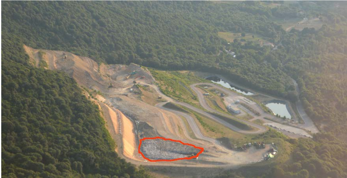
Illustration 5 : photographie aérienne de l'ISDND de Vico avec en sélection en rouge, la zone de travail évaluée à 2 500 m 2 , importante favorisant le nourrissage des oiseaux (source mission).
