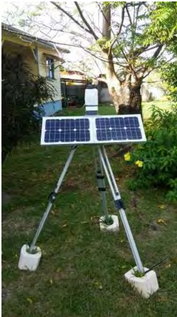
Photo 8: Capteur automatique de H 2 S et système de télétransmission installé au Robert
