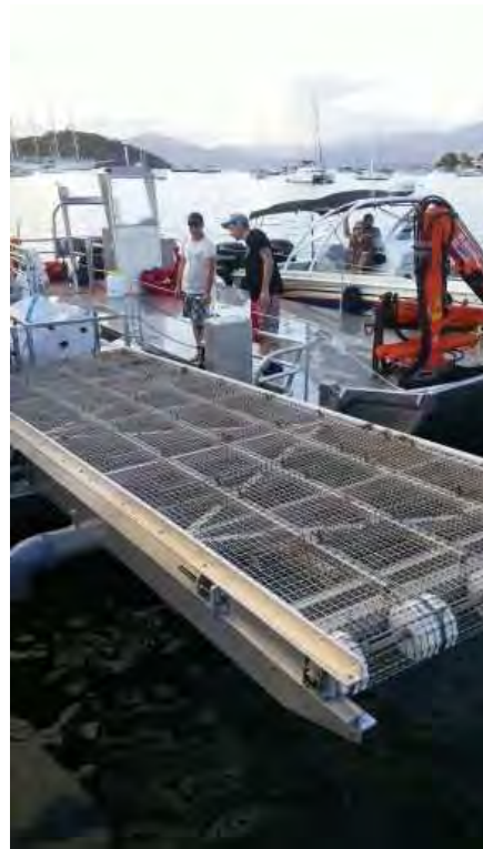
Photo 17: Convoyeur sur barge "Sargator"
