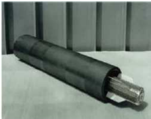
Un élément combustible dans sa chemise en graphite
