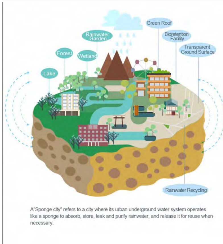
Figure 13 : Schéma de principe du plan « pour devenir une ville-éponge » de Chengdu (Chine). http://www.gochengdu.cn/news/special-reports/chengdu-plans-to-become-sponge-city--a1287.html
