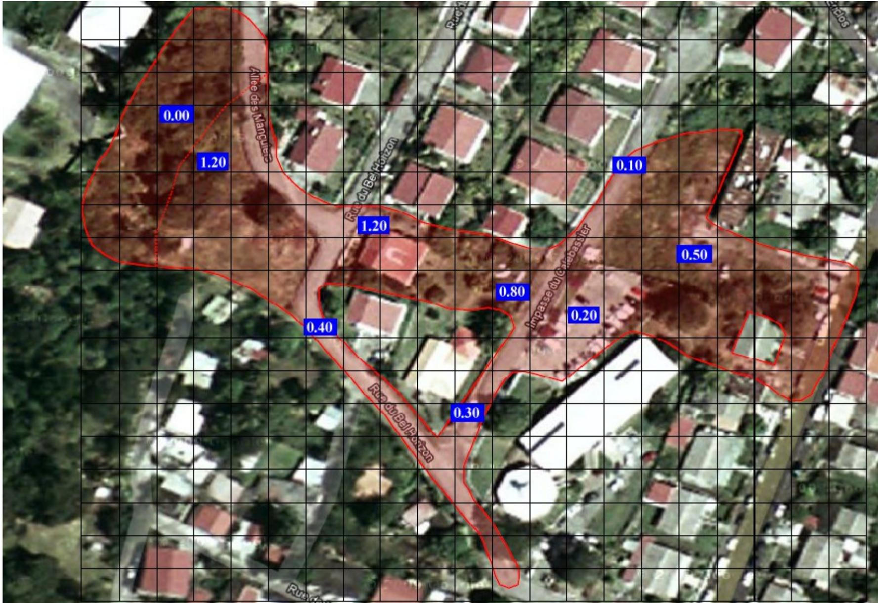
Figure 5 : cartographie et analyse de l'épaisseur de la coulée boueuse du 2 août 2011 (épaisseurs en mètres)
