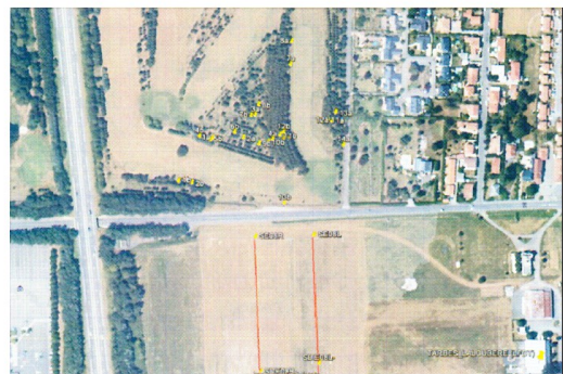
Vue aérienne du seuil 08 dont la trouée est grevée par les arbres en jaune
