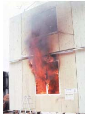
1.2 -Feu dans un compartiment composé de revêtement de parois non-combustibles (test 2)
