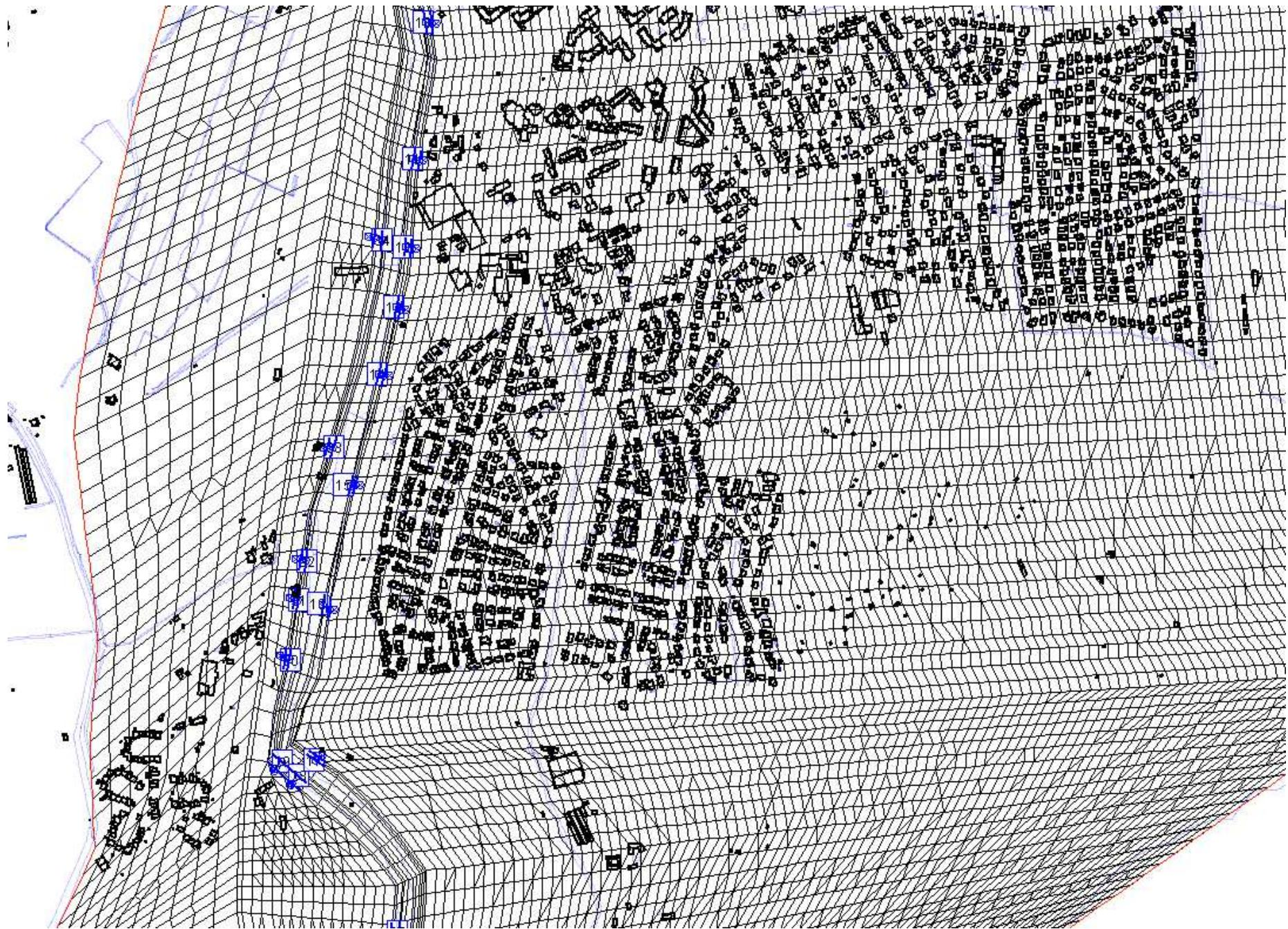
Figure 1c - Maillage de calcul et localisation des brèches (planches a à d du Nord au Sud)
