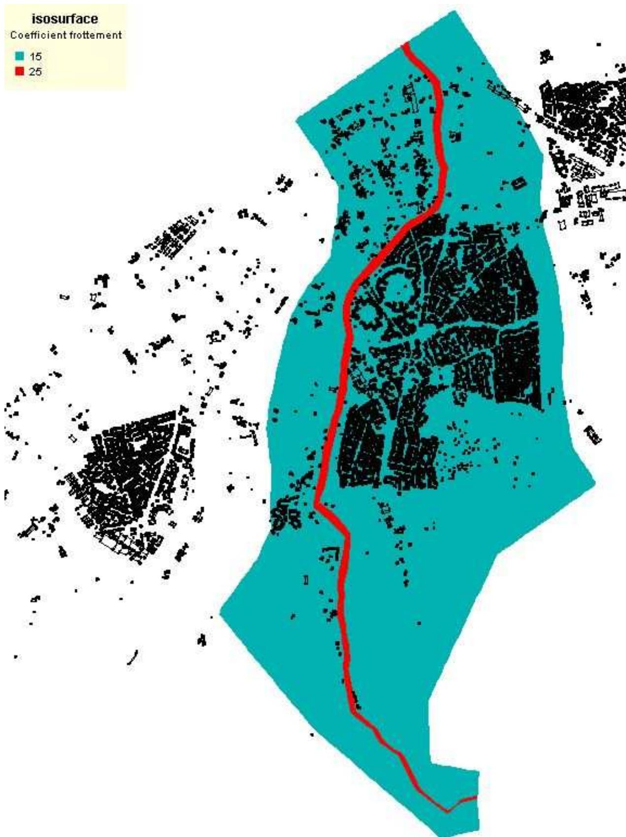
Figure 3 - Coefficients de Strickler utilisés
